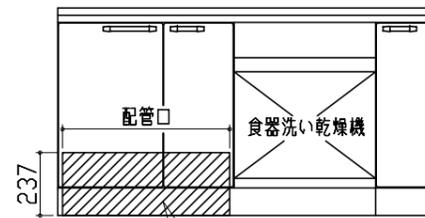
コンセント位置/配管口の下後壁 (15A-125Vアース端子付埋込)
