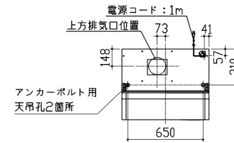
アルミダクト使用時の排気位置はダクト配管可能範囲を参照ください。直接排気の場合は、排気口の位置に内寸タテ160mm×ヨコ160mmで巾100mm以上の木枠を設けてください。実際の排気用接続部品の開口寸法は、角の場合150mm×150mm、丸の場合φ148です。
