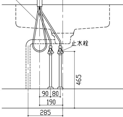
シンク下食器洗い乾燥機 配管例図
