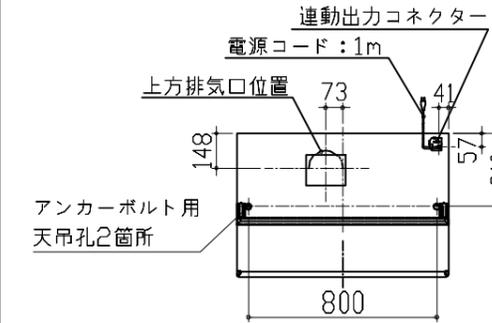
アルミダクト使用時の排気位置はダクト配管可能範囲を参照ください。直接排気の場合は、排気口の位置に内寸タテ160mm×ヨコ160mmで巾100mm以上の木枠を設けてください。実際の排気用接続部品の開口寸法は、角の場合150mm×150mm、丸の場合φ148です。
