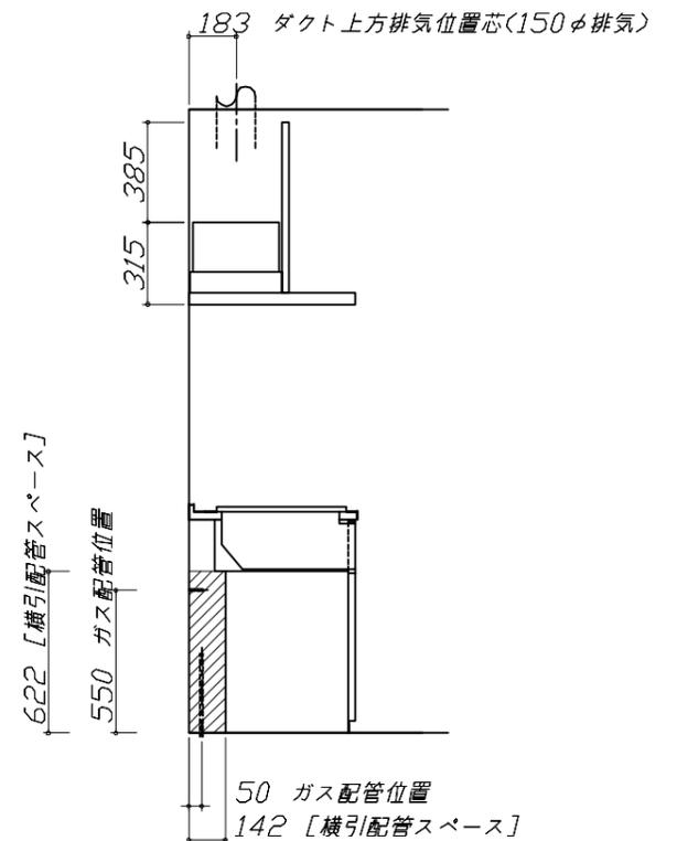
Zシンク給水排水配管例図
