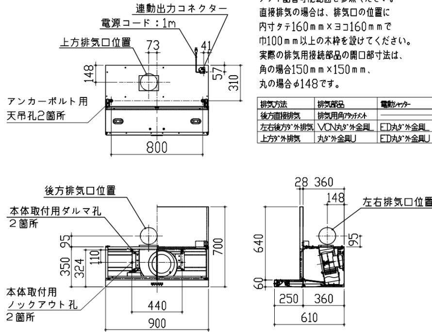
アルミダクト使用時の排気位置はダクト配管可能範囲を参照ください。直接排気の場合は、排気口の位置に内寸タテ160mm×ヨコ160mmで巾100mm以上の木枠を設けてください。実際の排気用接続部品の開口部寸法は、角の場合150mm×150mm、丸の場合φ148です。
