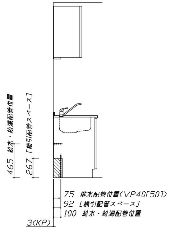
ZSシンク給水排水配管例図
