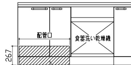
コンセント位置/配管口の下後壁(15A-125Vアース端子付埋込)
