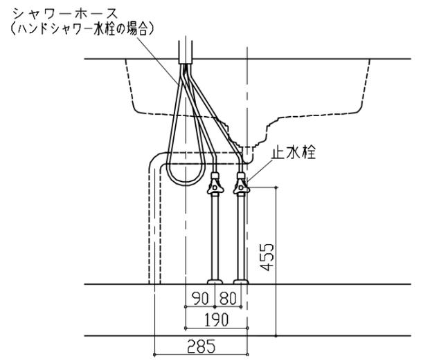
シンク下食器洗い乾燥機 配管例図
