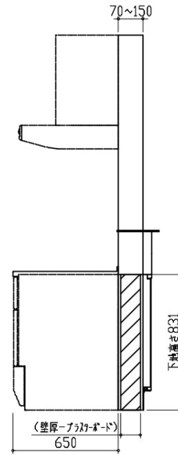
天井幕板施工例図
