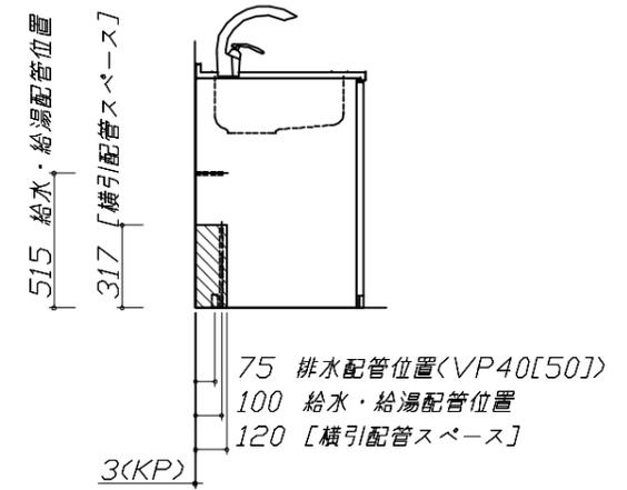
Zシンク給水排水配管例図
