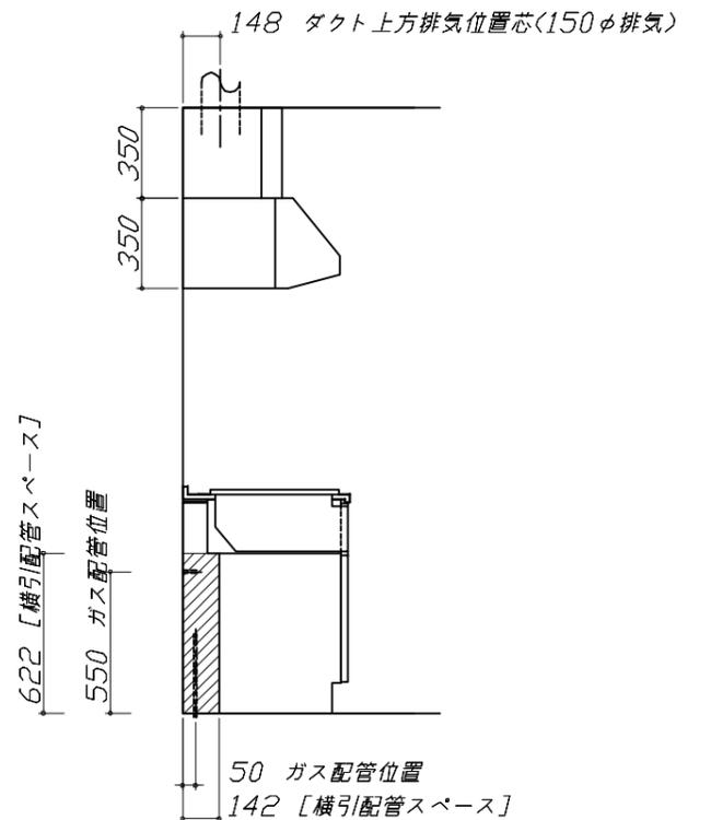
Zシンク給水排水配管例図
