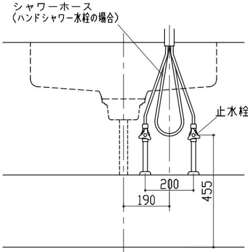
シンク下食器洗い乾燥機 配管例図
