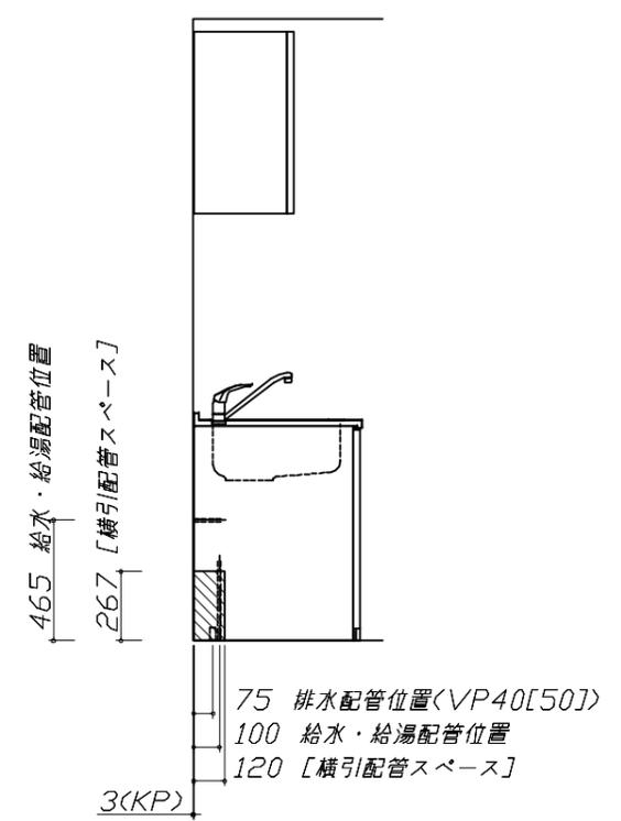
Zシンク給水排水配管例図
