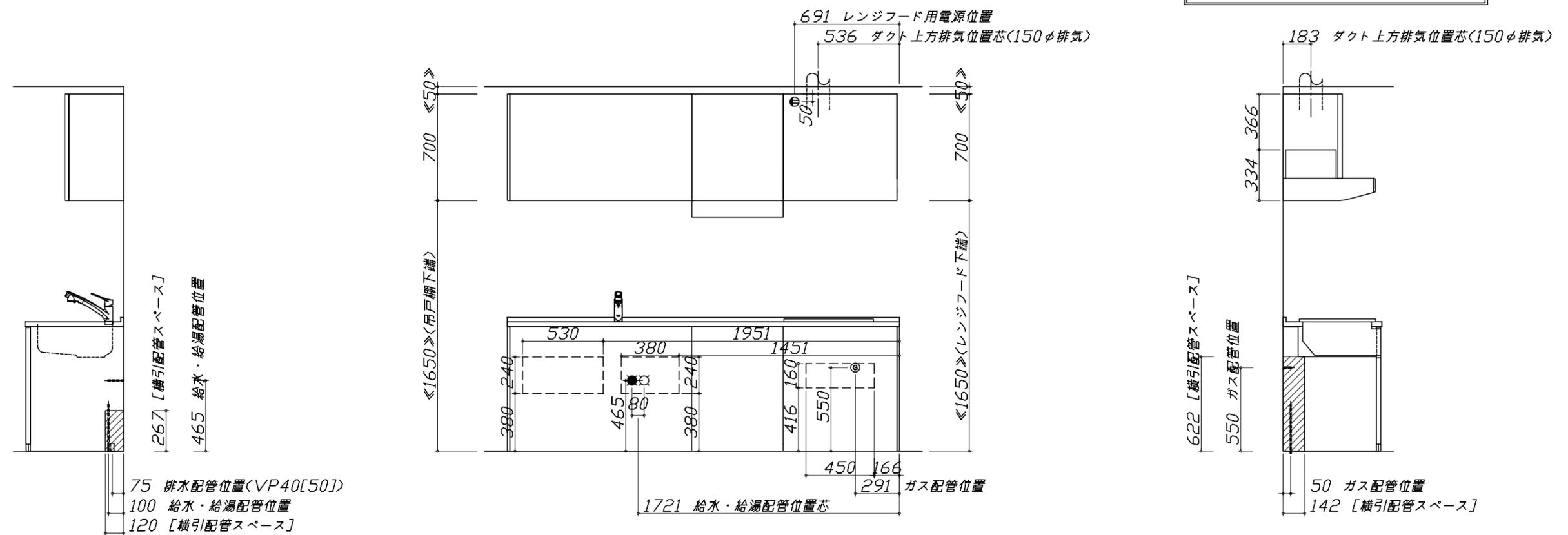
Zシンク給水排水配管例図
