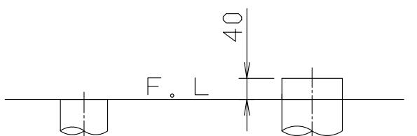
VP75の場合 床面カット VU75、VU、VP100の場合 床上40mmカット
