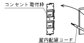
2、屋内配線コードの先端の被覆をコンセント裏面のストリップゲージ(16mm)に合わせてむき、取付枠裏面の接続穴に直角に奥まで差し込んでください。
