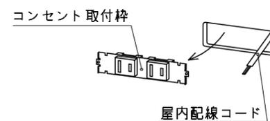
2. 屋内配線コードの先端の被覆をコンセント裏面のストリップゲージ(16mm)に合わせてむき、取付枠裏面の接続穴に直角に奥まで差し込んでください。
